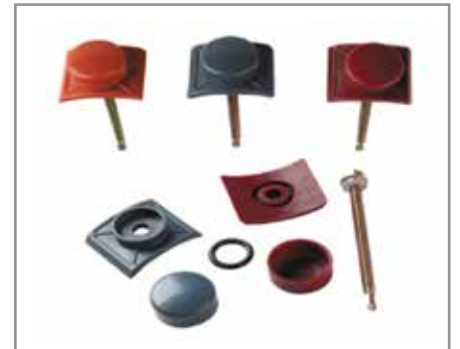
Phụ kiện lắp đặt (bộ) Mã SP: Eurolines 09-PK Giống cao su - Tấm đệm (chống lốc, chống dột) - Nắp đậy (Không bao gồm vít bắn)
